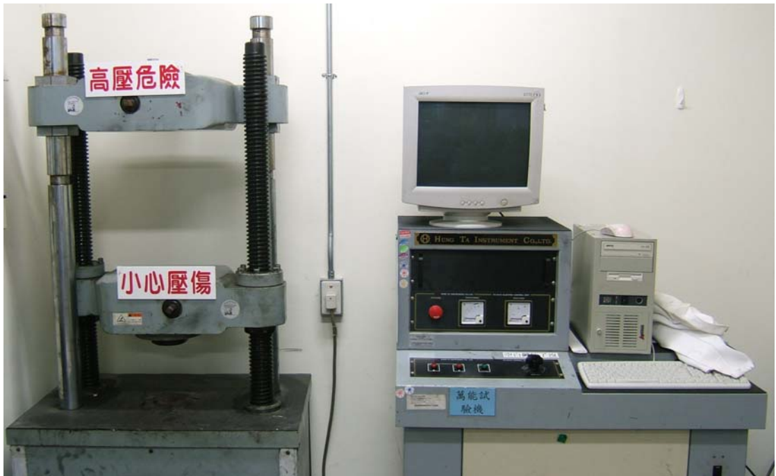
圖 3-2 50 噸萬能試驗機
