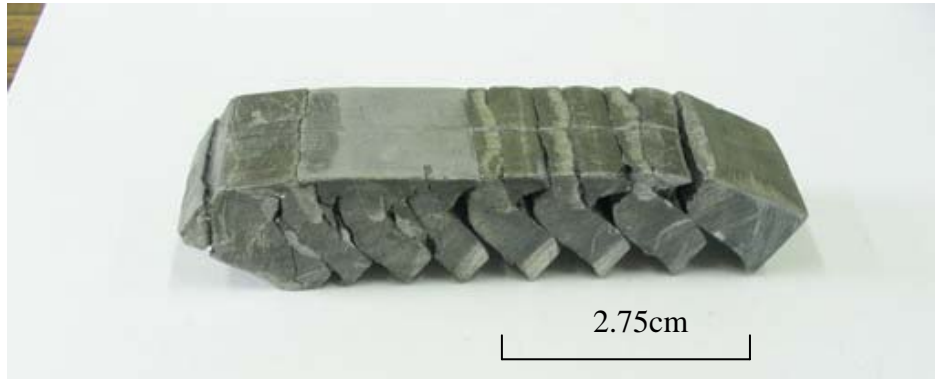
圖 4-1 常溫下經有外弧角模具擠型之試片
