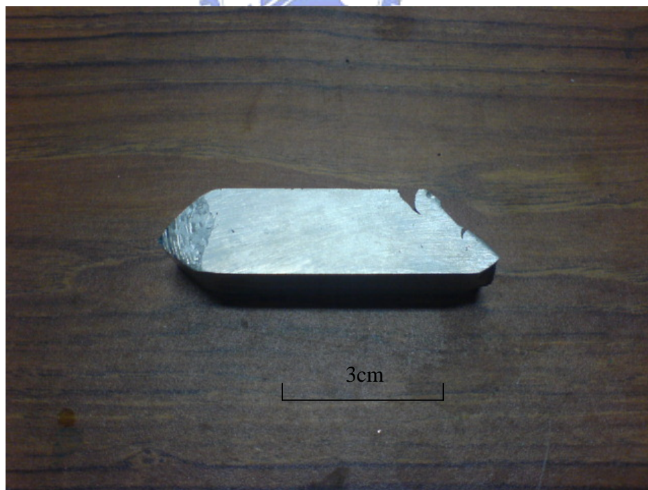
圖 4-4 A356 鋁合金經擠型後試片
