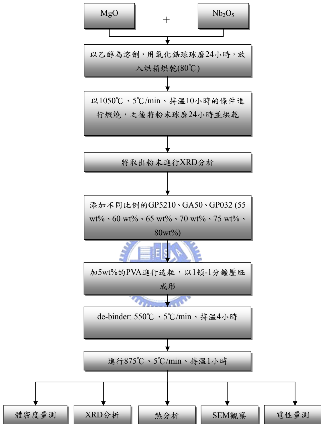
圖 4-2 低溫陶瓷塊材製程流程圖
