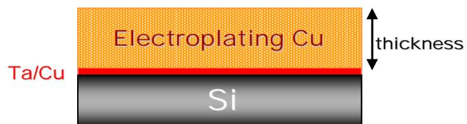
圖 4-13 退火步驟的實驗試片結構圖。
