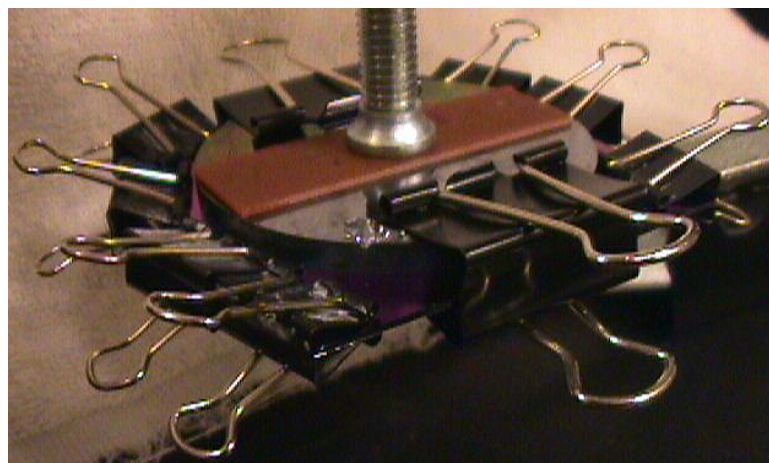
圖 4.10 試片以 C 型夾固定
