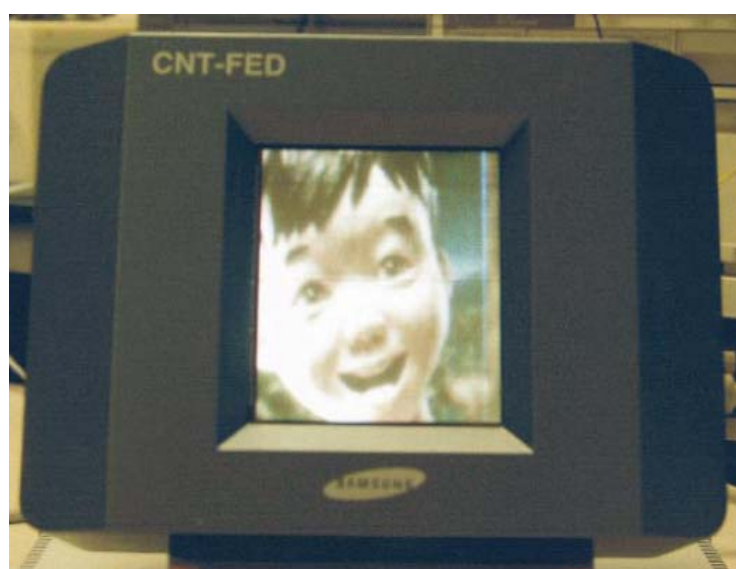
圖 2-18 三星電子在 2002 年所發表奈米碳管平面顯示器(CNT-FED) [70] 。
