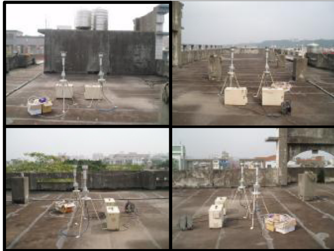
圖 3.3 大同國小採樣儀器現場設置情形
