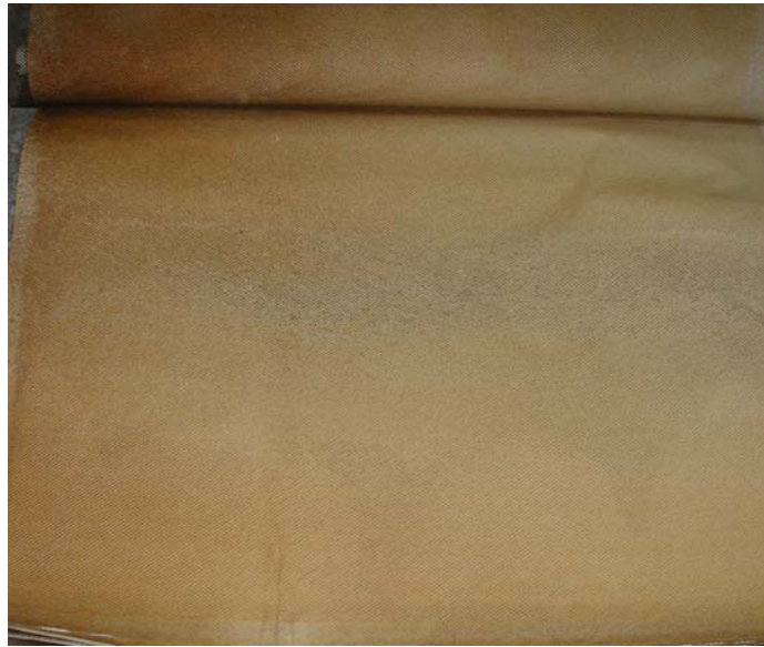
圖 4.10 烏坎海淡廠一廠 RO 膜解剖攤開照片
