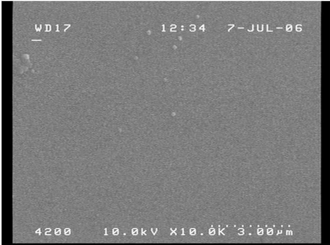
圖 4-5 絕緣層表面 SEM 照片 10000x
