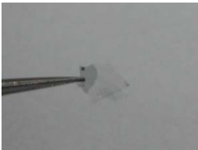
(a) 從 Si 上剝落的薄膜碎片
