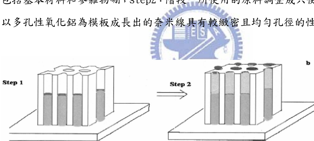
Fig 2-15 Intramolecular p-n junction 的製作步驟[35]
