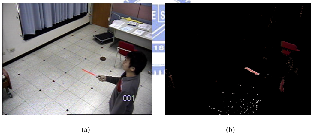
圖 2.6 (a) 攝影機輸入畫面、(b) 經過 HSI 過濾器處理後的結果
