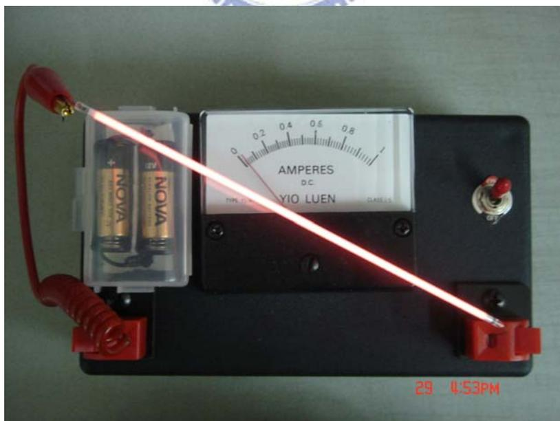
圖 4-81 以 $(Y_{0.75}Gd_{0.2}Eu_{0.05})(V_{0.4}P_{0.6})O_4$  所封裝之紅光燈管裝置示意圖
