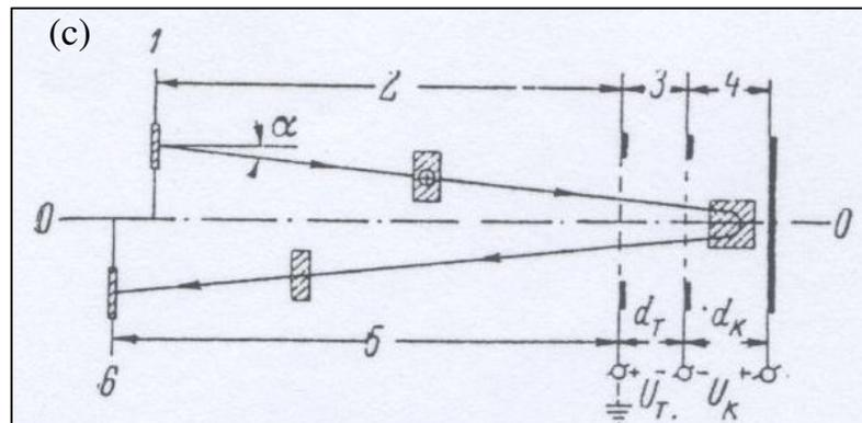
圖 2-4 (a)傳統直線型單階段式加速區(b)Wiley-McLaren 式直線型兩階段加速區飛行時間質譜儀簡圖(c)Mamyrin 提出的反射式飛行時間質譜儀簡圖，1 是離子束焦點、2 到 4 是到反射器前的自由飛行區、5 是經由反射器反射的自由飛行區及 6 是偵測器。
