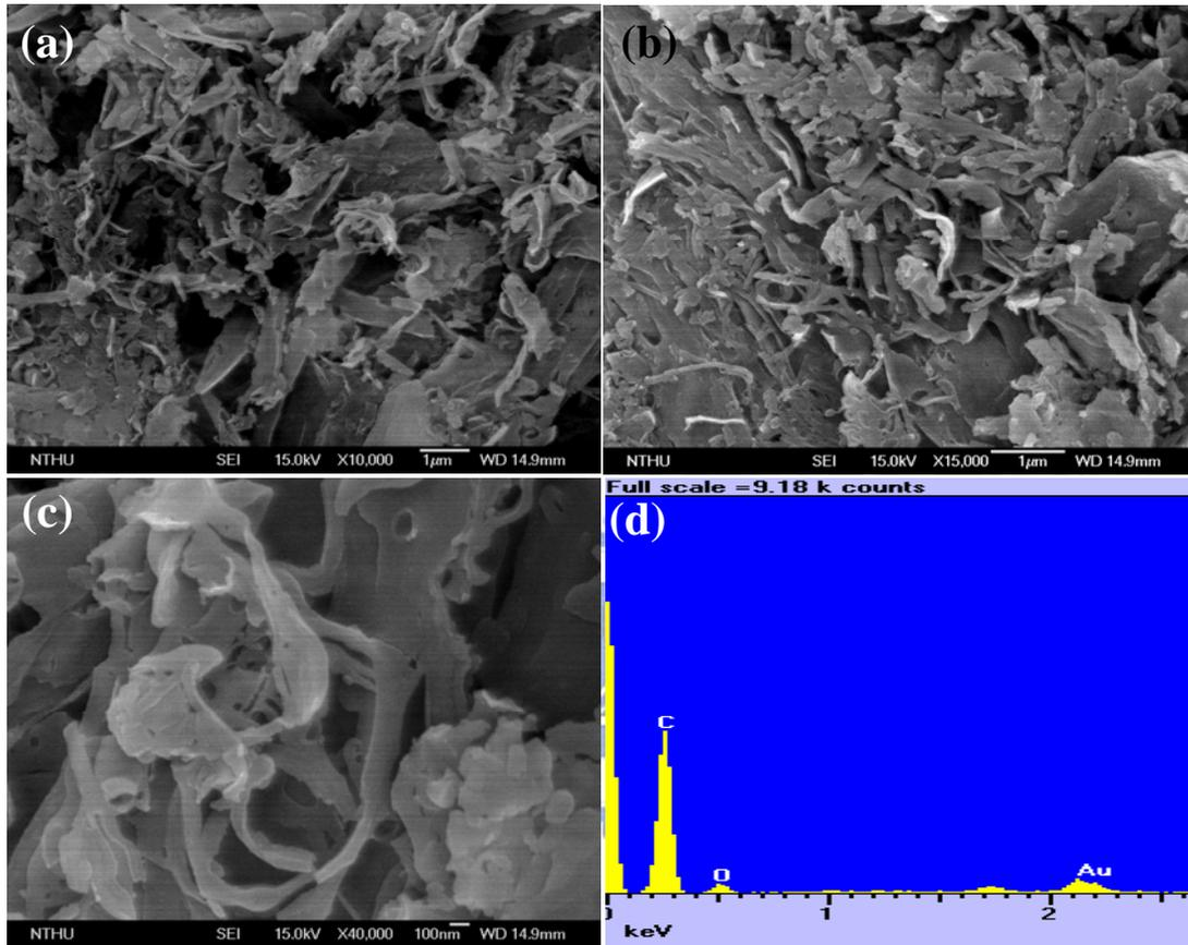
圖二 反應溫度 523 K 所得樣品 A1。 (a)、(b)、(c) SEM 影像圖，(d) EDS 分析圖。
