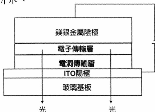
圖 1-1 電激發光元件示意圖
