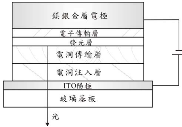
圖 1-3 普遍使用的三層式 OLED 元件結構
