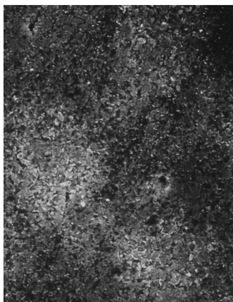
(C) Treated SPCE: 100 W 15 min (D) Treated SPCE: 300 W 10 min
