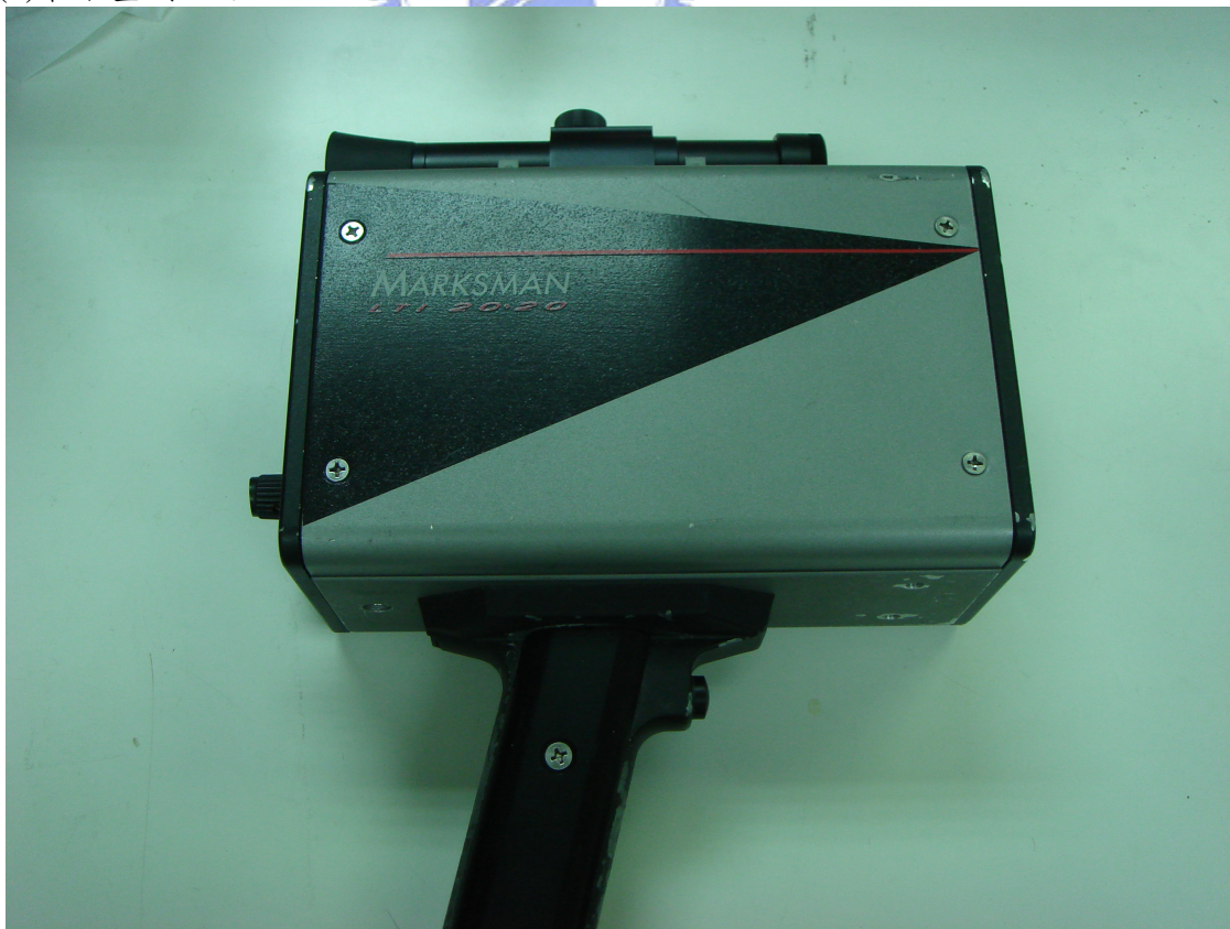
圖 10 Marksman LTI 20-20 雷射測速槍
