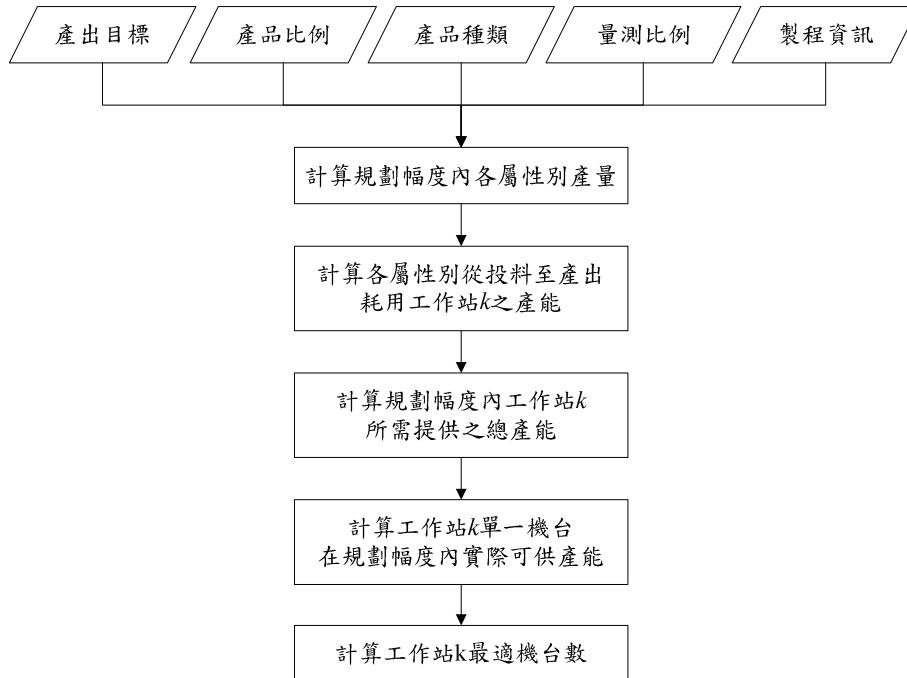
圖 3-4、陣列階段製程各工作站之機台數估算流程
