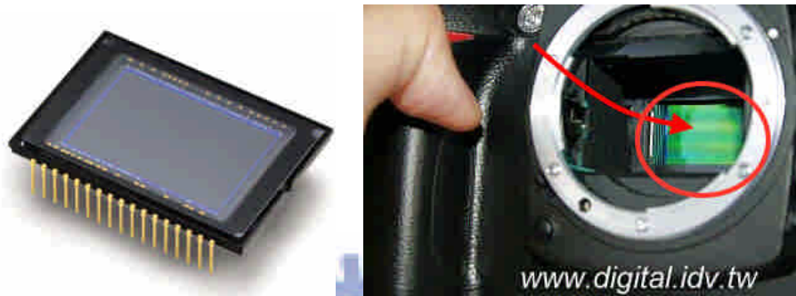
圖 2. 左圖：NikonD100 CCD；右圖：Nikon D70 鎖上反光鏡後 CCD 露出之位置
