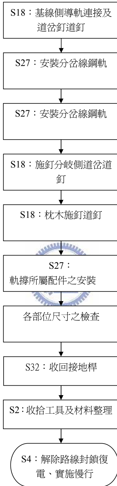
圖 4-13 抽換道岔作業流程圖
