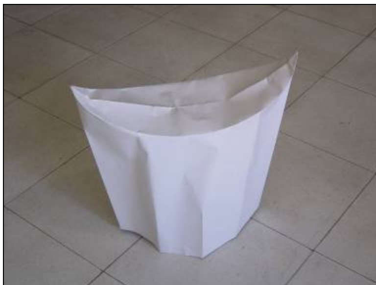
圖 4-26 《再生紙之椅》1:1 草模（結構堅固程度測試）
