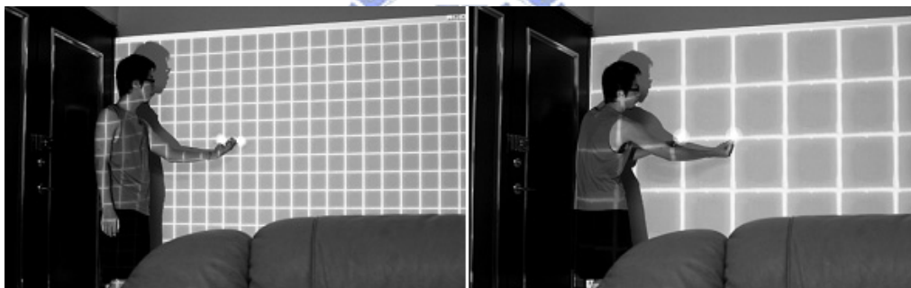
Figure. 26. 透過程式計算，將像素轉換成精確的實體距離
