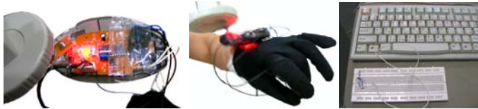
圖 37 利用支架和電路的整合將滑鼠改裝，並安置在手腕上方；同時將“alt”鍵的感應線路接在麵包板上。
