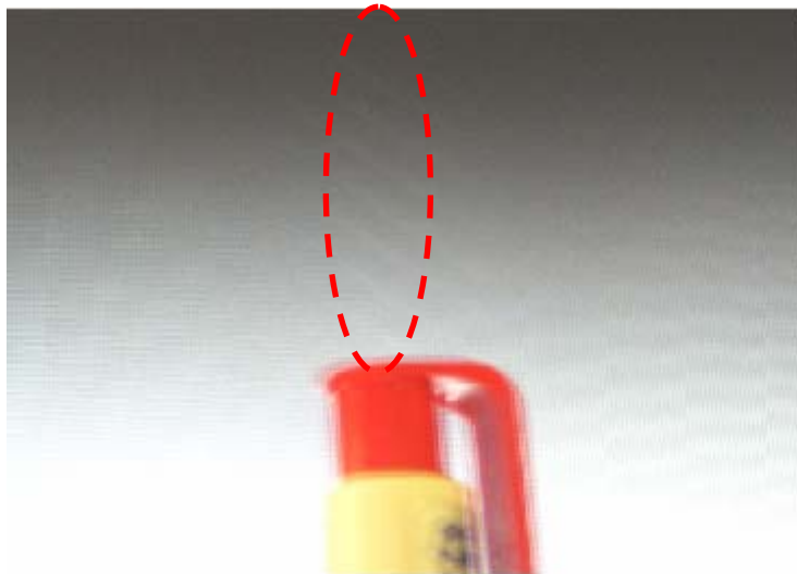
圖 1-7 樹脂幕那，如圖中虛線包含的區域造成亮暗不均幕那現象
