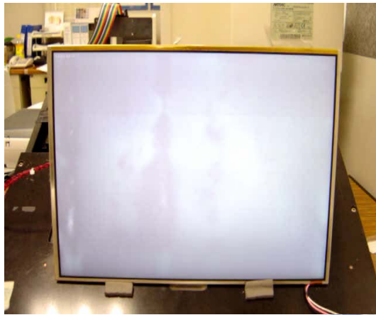
圖 1-8(e)時間= 300 msec 放電 幕那的現象
