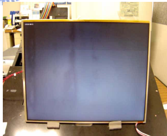
圖 1-8(b)時間= 30 msec 放電幕 那的現象
