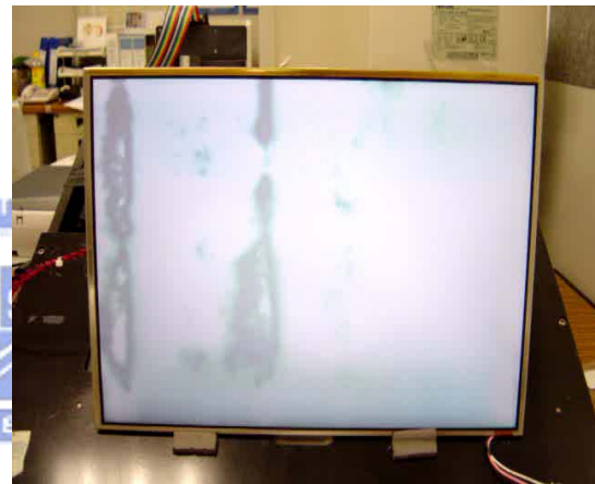
圖 1-8(f)時間= 450 msec 放電 幕那的現象
