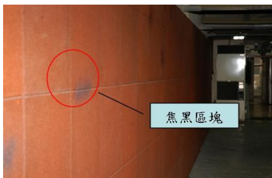
圖 3.11、防彈膠磚遭射擊情形
