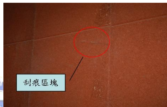
圖 3.12、防彈膠磚遭跳彈射擊
