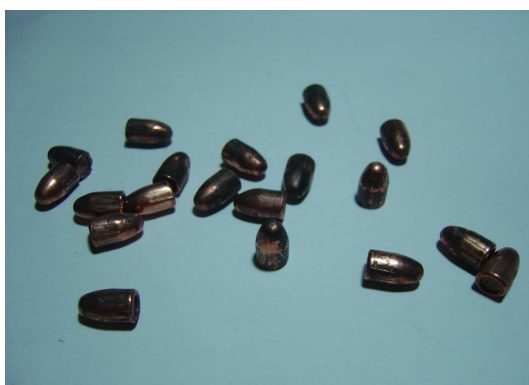
圖 2.23、射至軟式捕彈陷阱留下完整之彈頭
