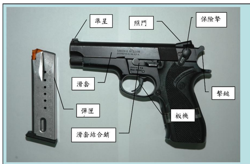
圖 2.17 S&W 九釐米手槍手槍基本構造圖
