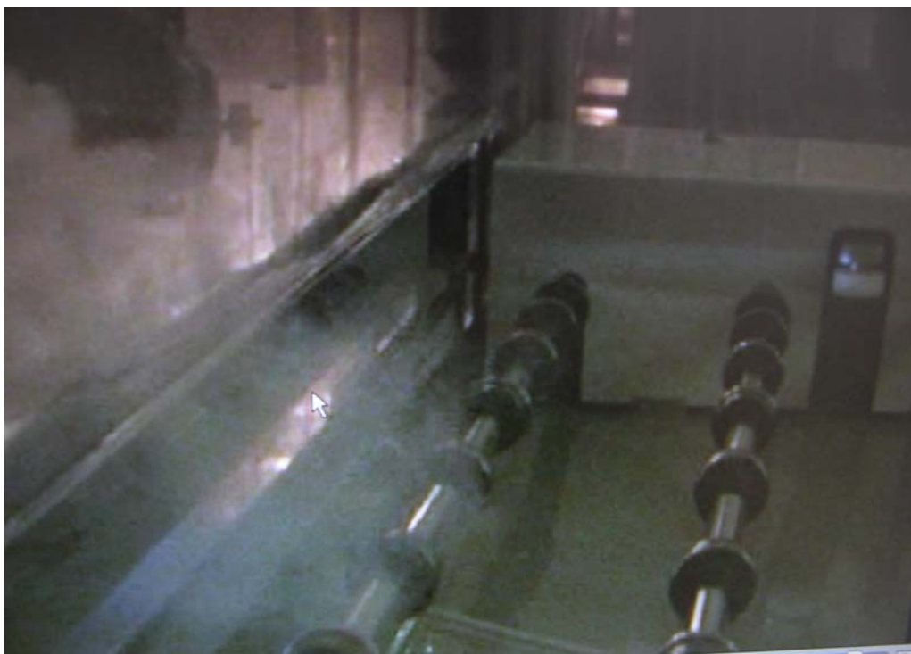
圖 28 UV 清洗機出片時氣流往出片方向逸散狀態
