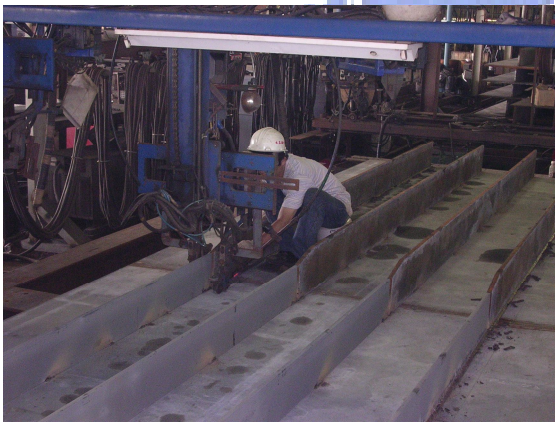
圖 5-7 下翼板與加勁板先行潛弧銲接
