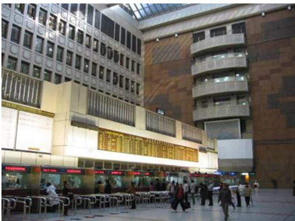
G+1挑高空間未設置自動滅火設備防護
