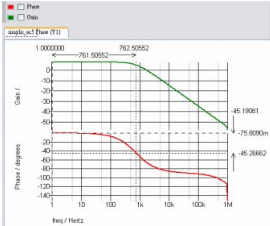
圖 20. 圖 19 中電源級電路模擬的頻率響應特性曲線。
