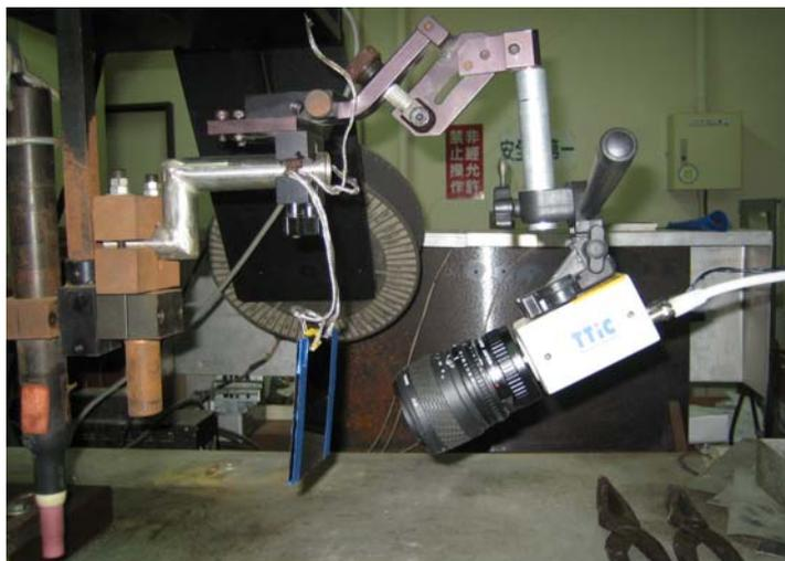
圖 3-6 CCD 鏡頭架設圖
