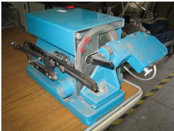
圖 3-4 鎢電極研磨器
