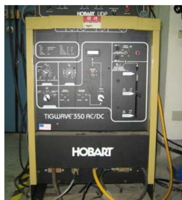
(c)電壓/電流控制器
