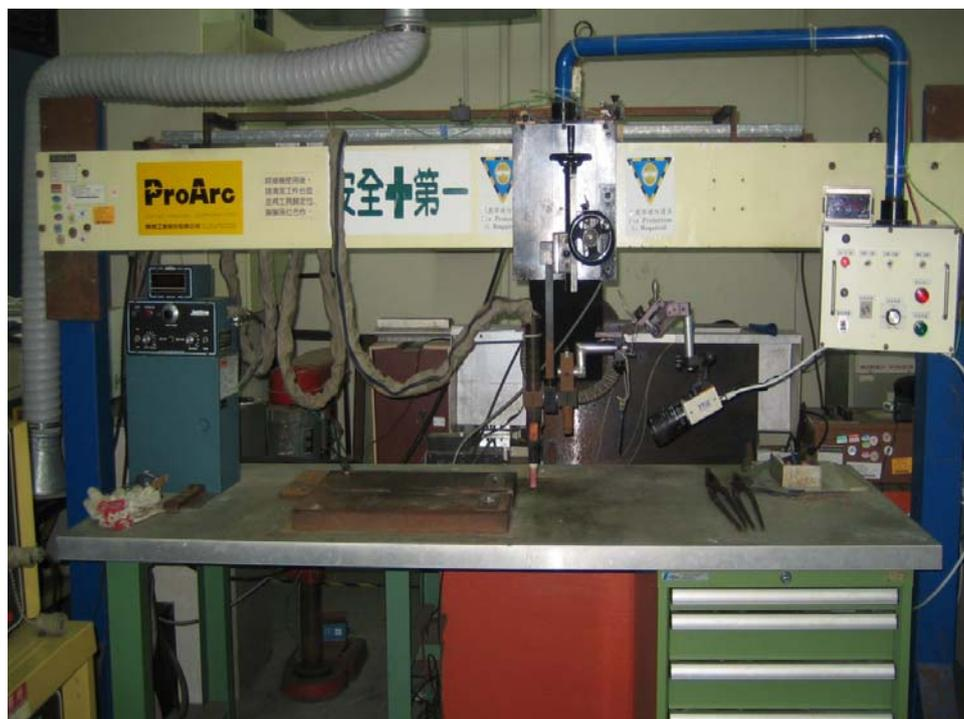
圖 3-3 HOBART 惰氣鎢極電弧鐳接機—鐳接檯與其配件
