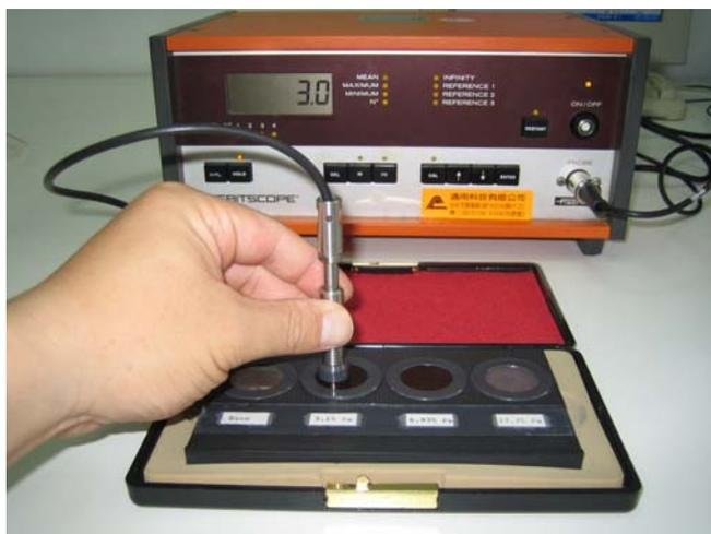
圖 3-11 FerritScope M10B-FE 型肥粒相測定儀
