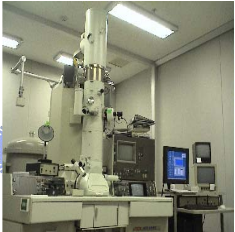
圖 3-5 穿透式電子顯微鏡 照片 [33]
