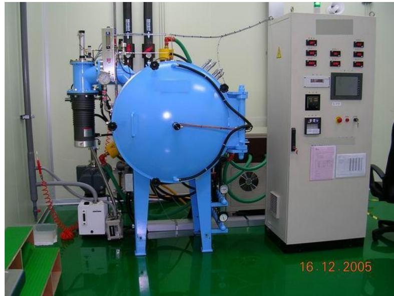
圖 3-2 真空銲接爐 中國砂輪提供
