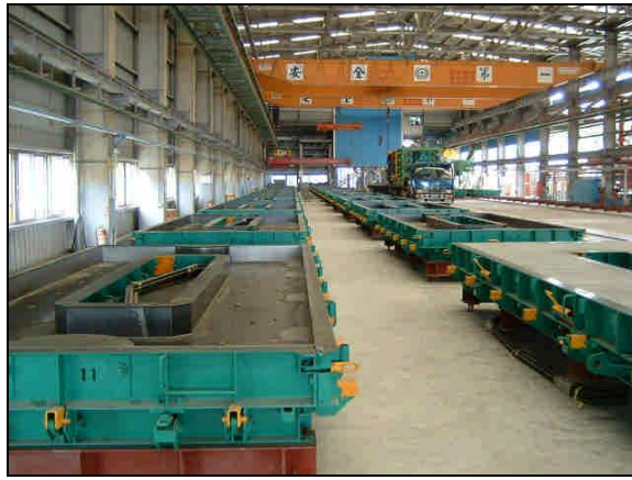
(1)軌道版鋼模組立
