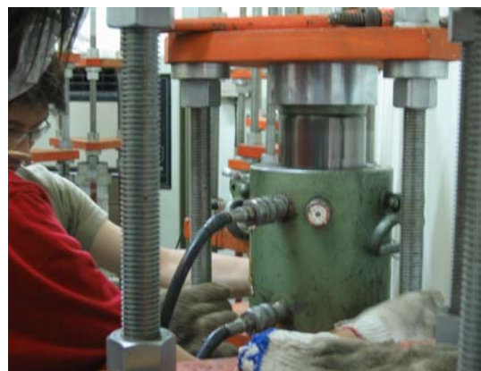
照片 3-17 加預載力儀器
