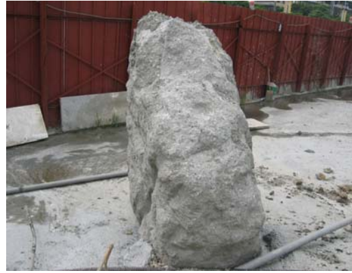
照片 4-5 SCC 漏漿之狀態
