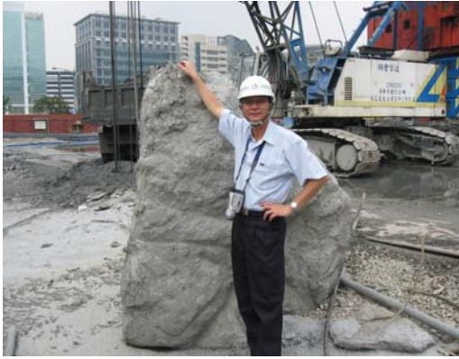
照片 4-5 SCC 漏漿之狀態
