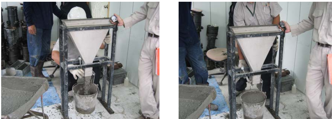
照片 3-3 鋼製 V 型漏斗儀器及試驗
