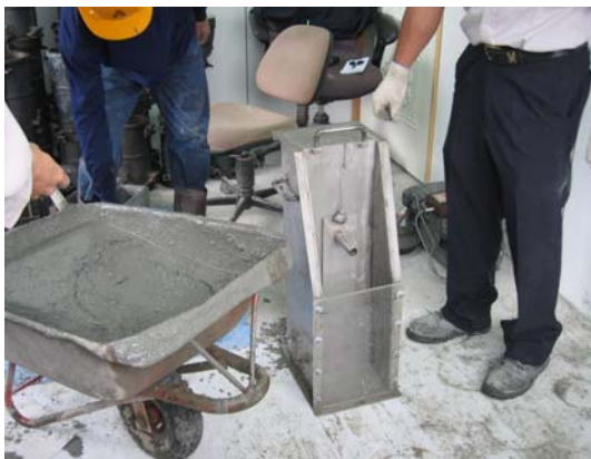
照片 3-4 箱型槽儀器
