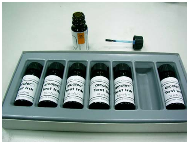
Fig. 3.8 達因測試法使用之 Arcotest Test ink 達因試劑
