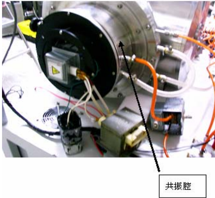
Fig. 3.16 共振腔結構設計及磁控管組
