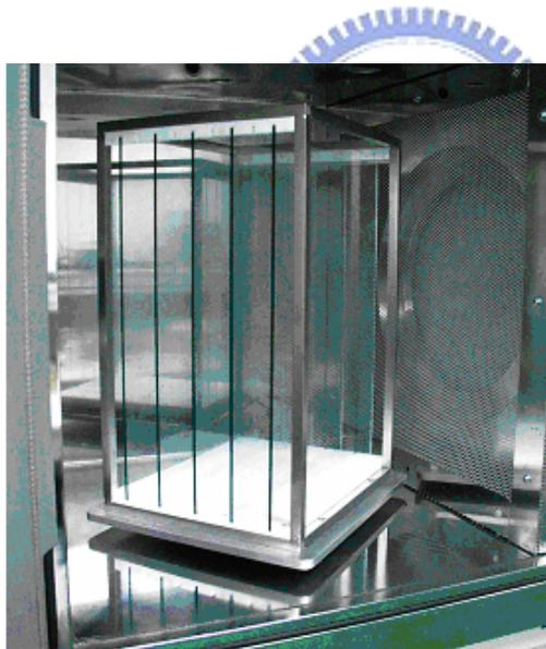
Fig. 4.21 PET 基板電漿清洗腔內結構照
