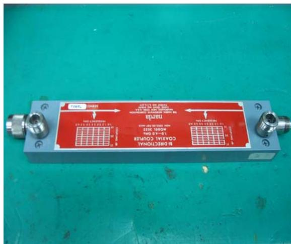
Fig. 4.17 方向耦合器
