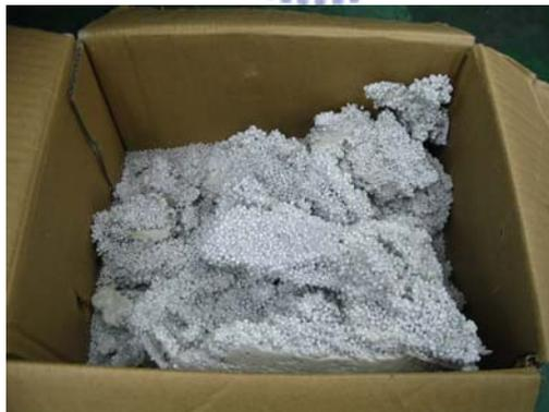
Fig. 4.11 PET 粒子處理溫度過高，粒子熔化現象
