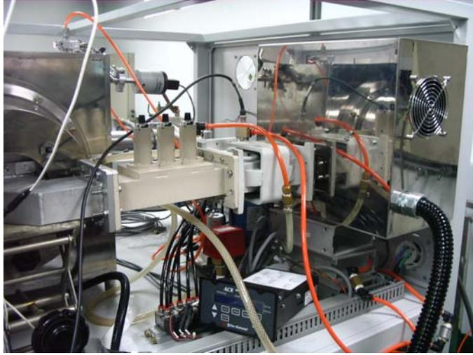
Fig. 4.22 PET 基板電漿清洗微波源結構
