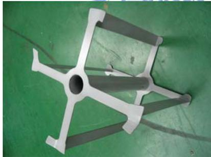
Fig. 4.7 不銹鋼表面熔射 Teflon 轉動葉片之設計
