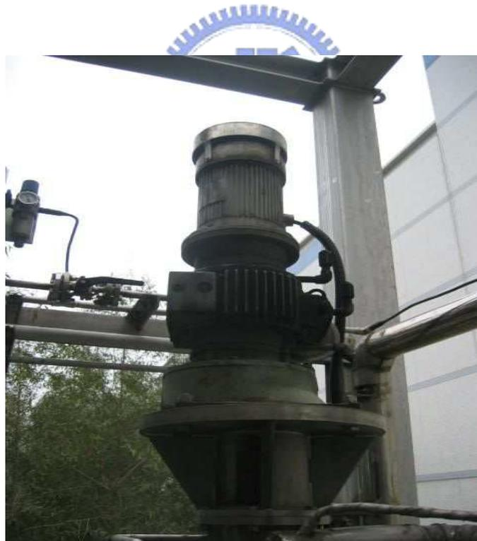
圖 3-6 本研究案例光電廠薄膜蒸發器轉動馬達
