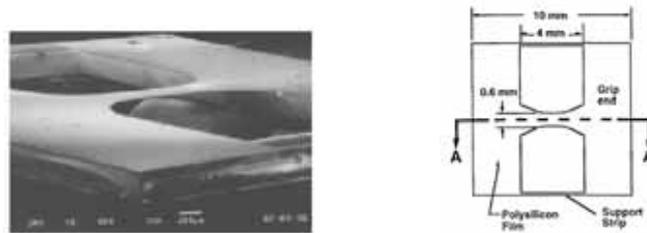
圖 1.19 左圖為微拉伸實驗試片掃描式電子顯微鏡(SEM)影像圖，右圖為試片尺寸圖[14]。
