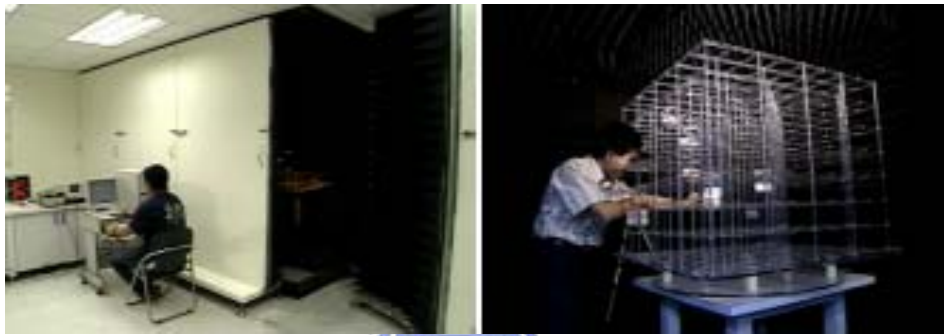
圖 7.1 靜態測試最低開啟功率量測實景圖
