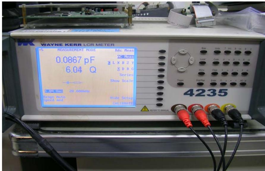
圖4.19 LCR METER儀器實體圖
