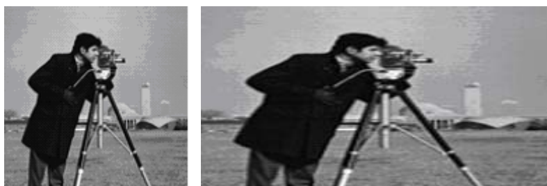
圖 2.10 利用一維度 Cubic Convolution 作影像內插補點的結果。
