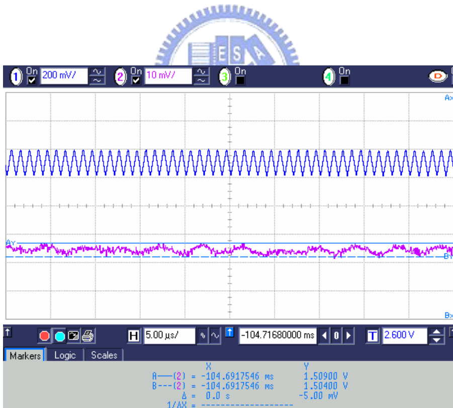
圖 4.38 穩壓器晶片外部沒有接負載電容時，當輸入電壓含有 1 MHz、200 mV 峰對峰值的漣波雜訊，量測拒斥雜訊的能力。
