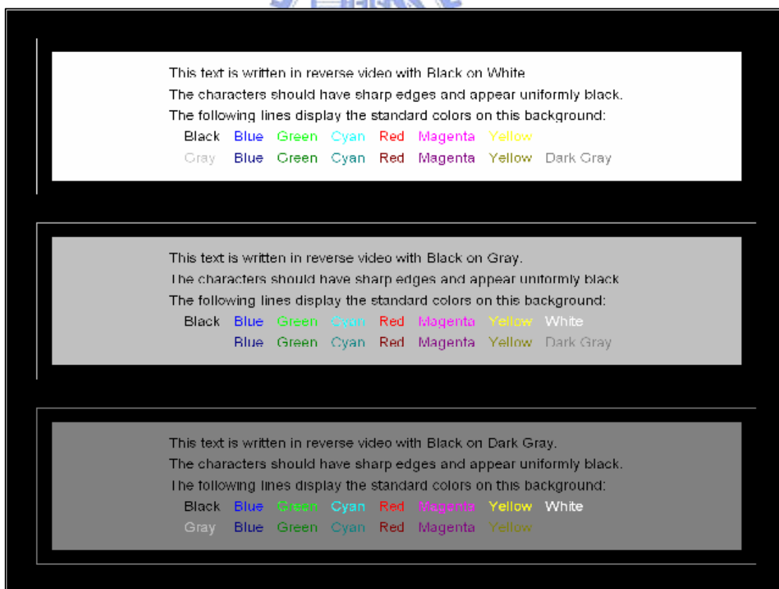
圖 2-30 邊框與文字影像：由原始 1280×1024 標準影像經 Nearest Neighbor 縮小到 640×480 的影像，用來作為後續放大回 1280×1024 的基準。
