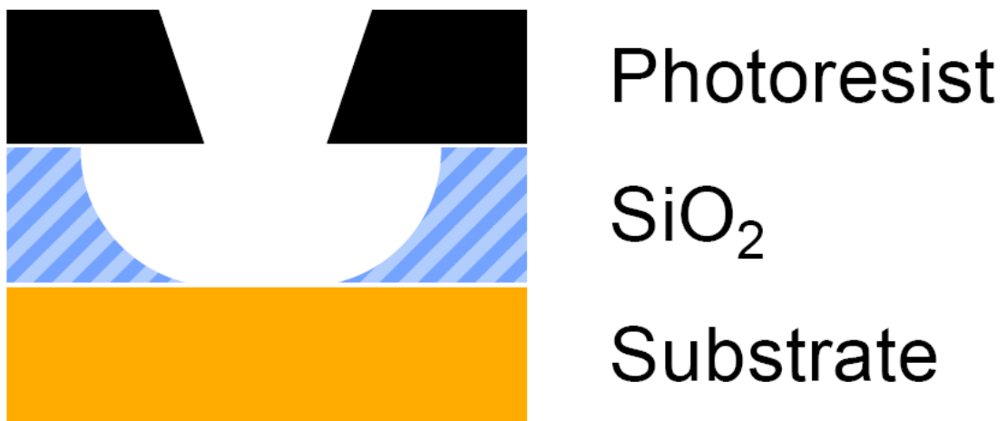
圖3-9 濕式蝕刻(Wet etch)所形成的圖形
