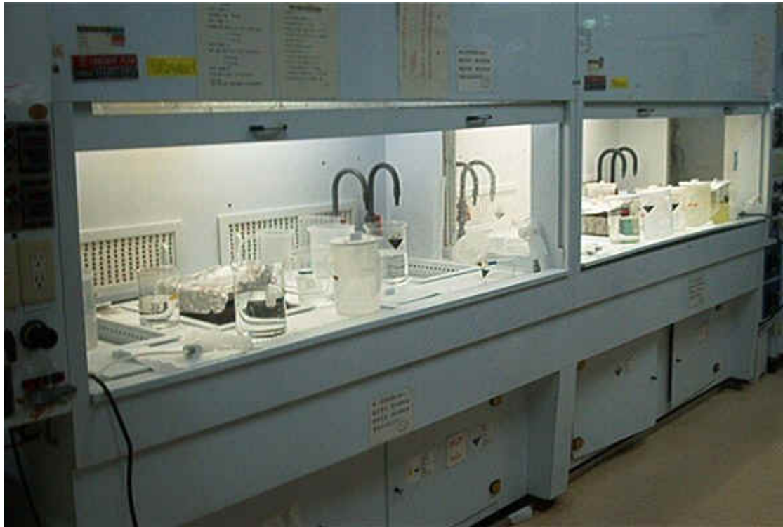
圖3-10 交通大學奈米中心_濕式清洗(Wet Bench)機台
