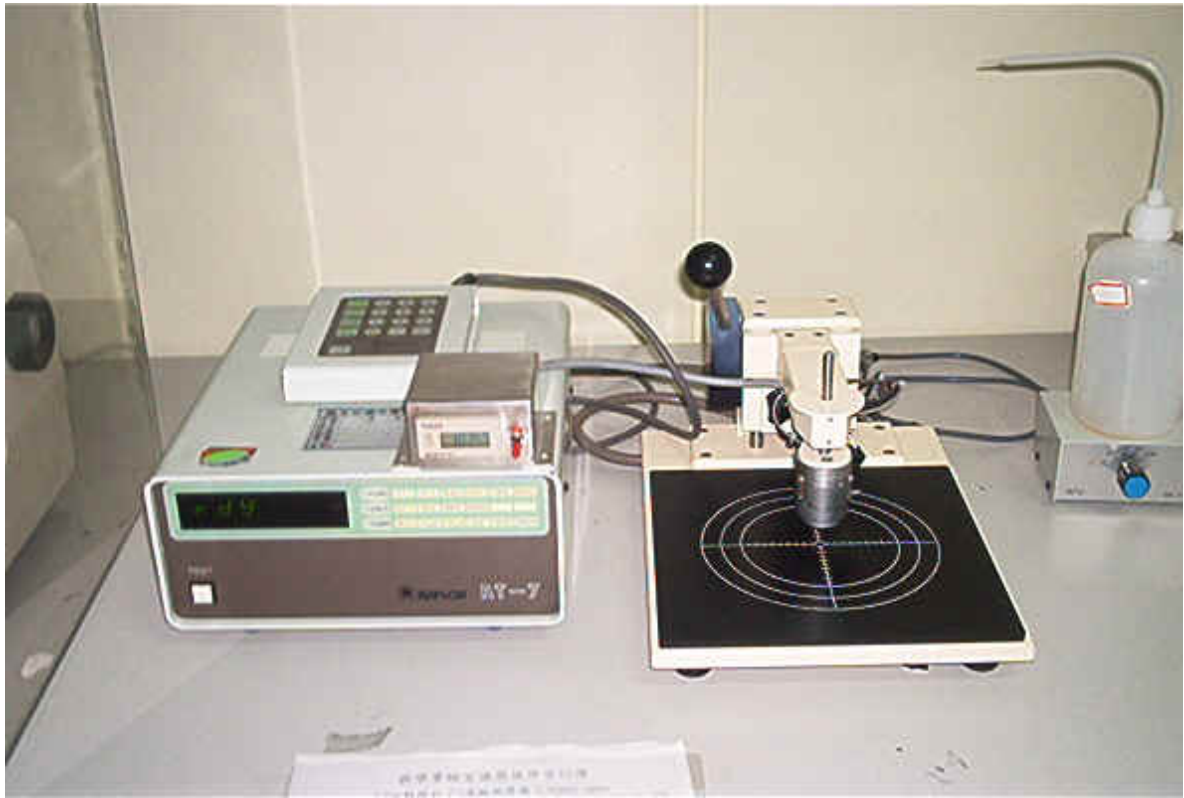
圖3-18 交通大學奈米中心_四點探針儀(Four-Point Probe)
