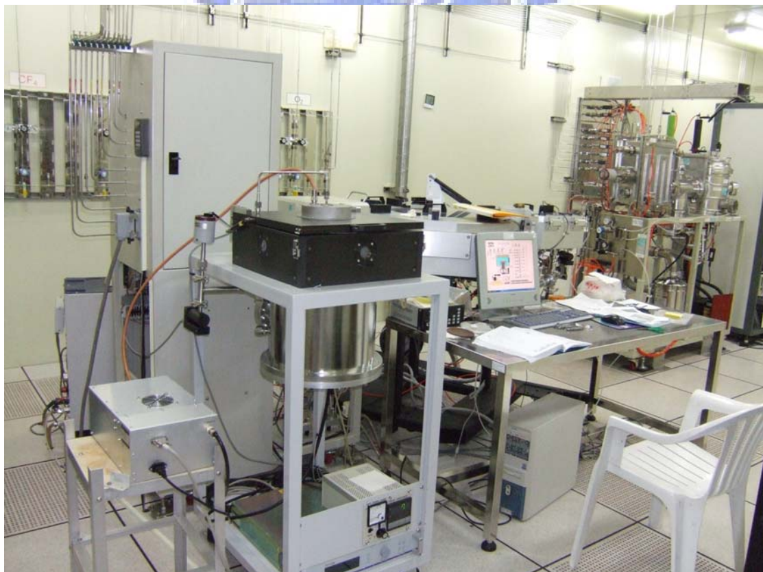
圖3-14 中興大學電機學院_電漿輔助化學氣相沈積機台(PECVD)
