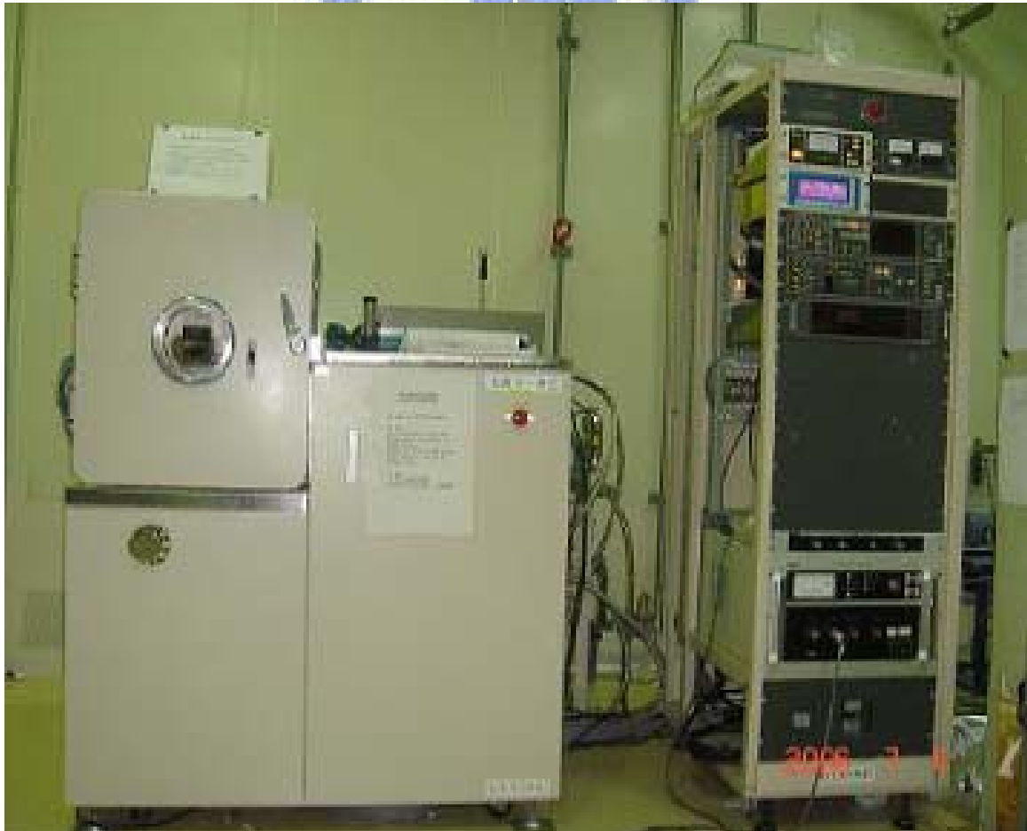
圖3-19 交通大學奈米中心_電子槍蒸鍍系統(E-Gun Evaporator)
