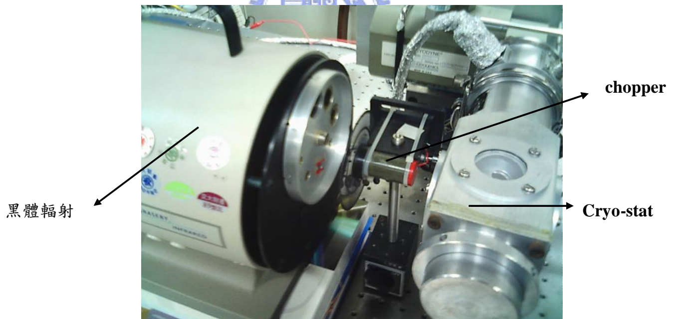
圖 4-6 光電流量測之實際儀器架設圖
