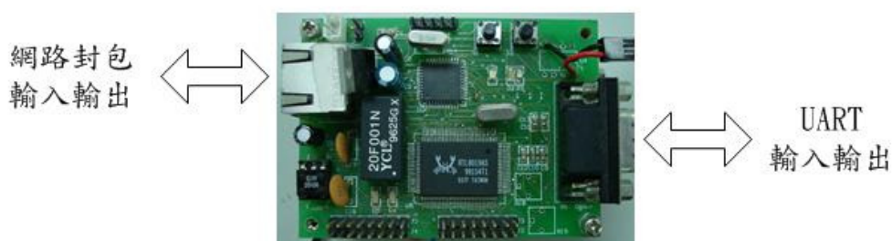
圖 30 PIC Ethernet 嵌入式網路板
