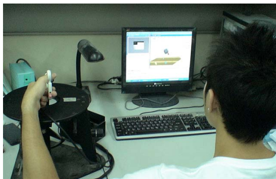
圖 4-2 操作者在近端進行遠端操控的情形
