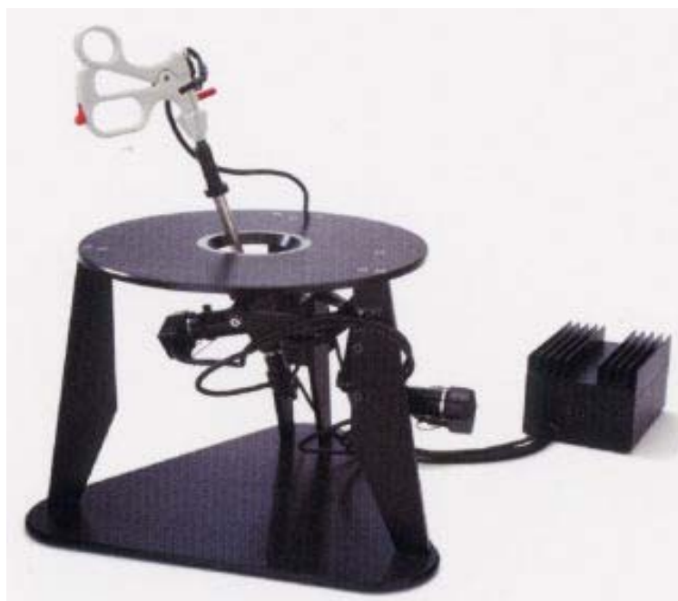
圖 3-13 Laparoscopic impulse engine
