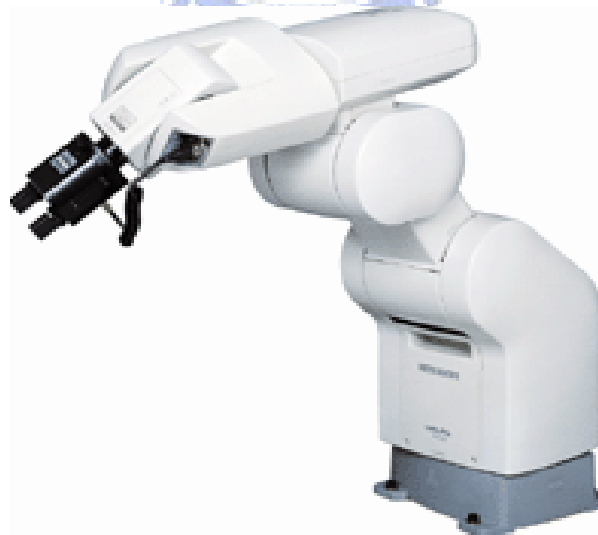
圖 3-11 Mitsubishi RV-2A 五軸機械手臂外觀
