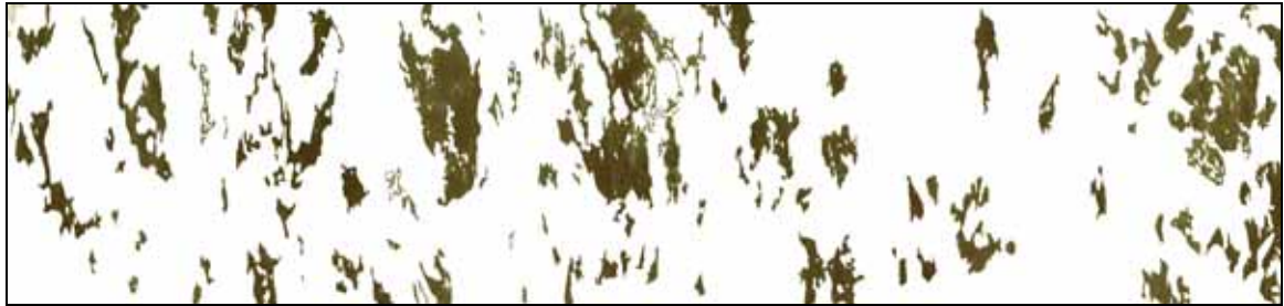
(b) 7 天齡期孔隙分佈圖 (孔隙率 14.87%)
