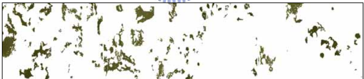
(d) 28 天齡期孔隙分佈圖(孔隙率=10.60%)
