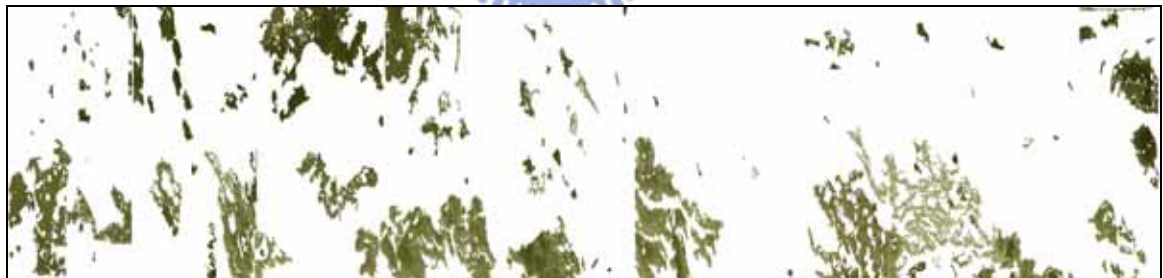
(d) 28 天齡期孔隙分佈圖 (孔隙率 12.37%)
