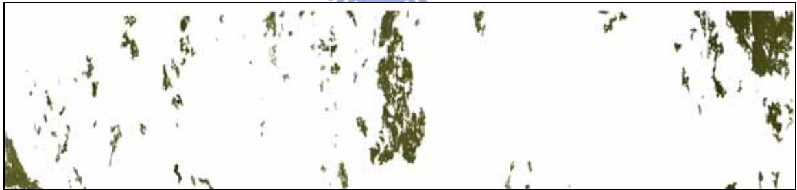
(d) 28 天齡期孔隙分佈圖 (孔隙率 7.44%)
