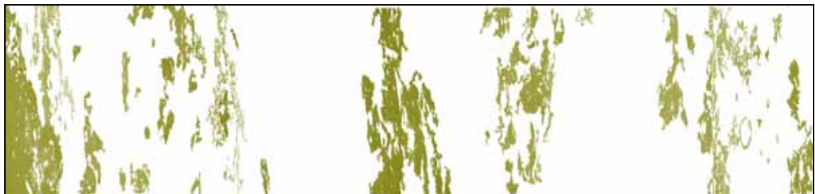
(c) 14 天齡期孔隙分佈圖 (孔隙率 16.41%)
