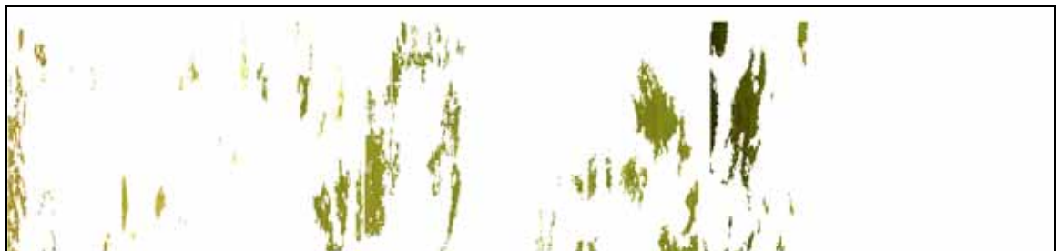
(e) 56 天齡期孔隙分佈圖 (孔隙率 9.75%)
