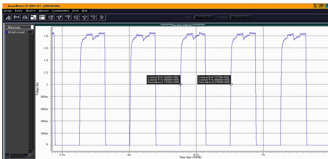
圖 2.33 TT Output Oscillation frequency
