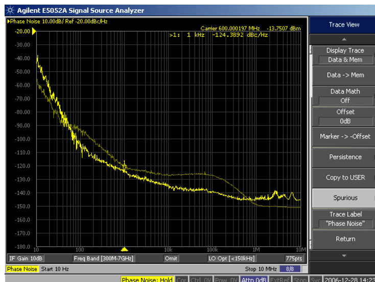
圖 3.45 SSHSH input and output phase noise
